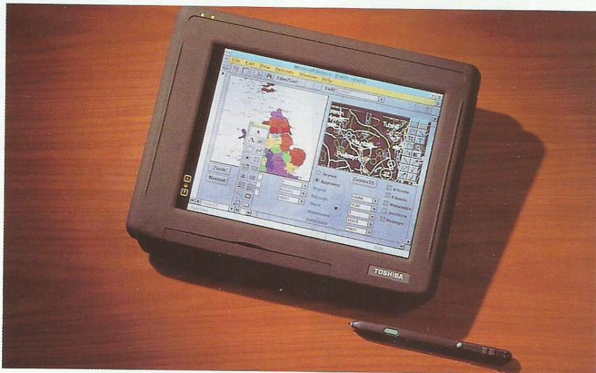
*El Toshiba T200/T200CS se convierte en el primer ordenador PenComputer dotado con pantalla en color y procesador i486DX2 de 40 MHz.*
