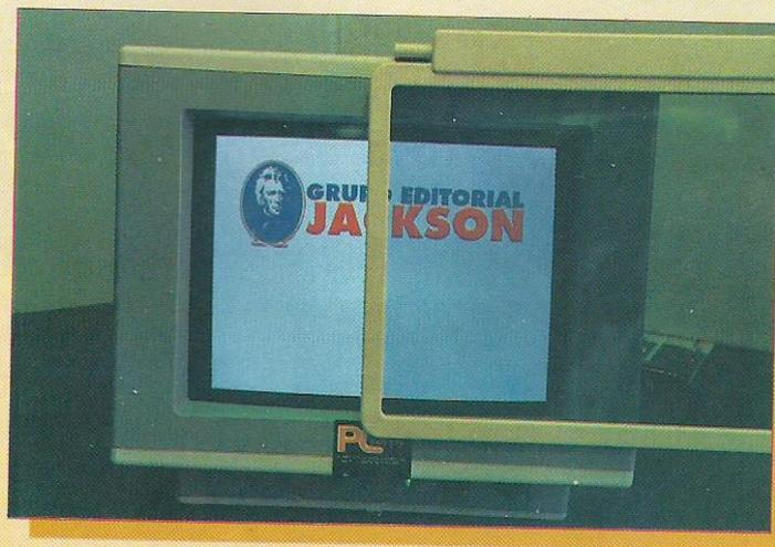
**N543:** SCR Computer ofrece un filtro de cristal para pantalla que elimina las radiaciones, reflejos, transmisión de luminosidad, cargas electroestáticas y reduce el cansancio visual del usuario.
