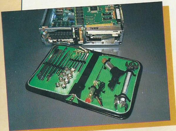
**N541:** Grupo Editorial Jackson ofrece un kit de herramientas compuesto por tres llaves fijas, cinco llaves hexagonales, un destornillador de carraca con siete bocas intercambiables, ocho llaves de vaso, y un comprobador de corriente.
