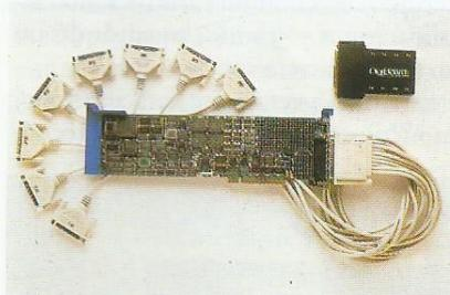
El MC/Xe incorpora un microprocesador 80186 a 8 MHz, que proporciona gran capacidad de cálculo en la tarjeta, y cada uno de los productos ejecuta el software PFront End Processing/Operating System (FEP/OS), para reducir la sobrecarga de la CPU en las tareas de E/S serie al menos del 0,5 por ciento de su capacidad total.
